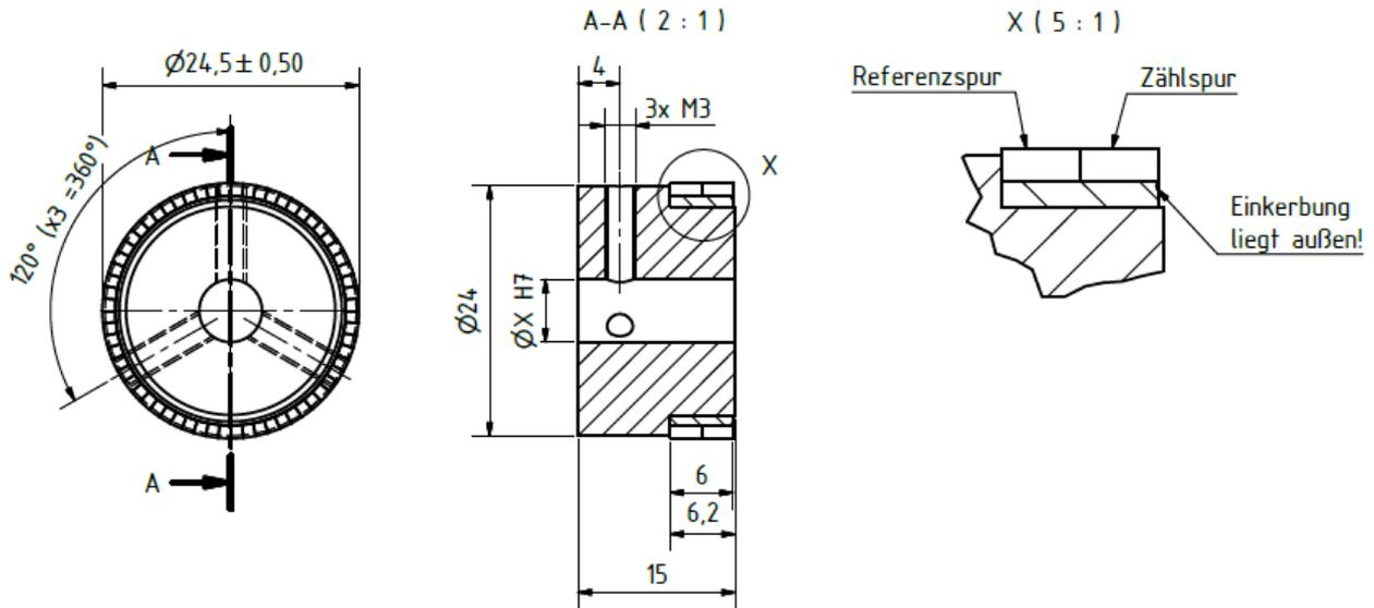
**Magnetring** (Montage durch Schrumpfen)
