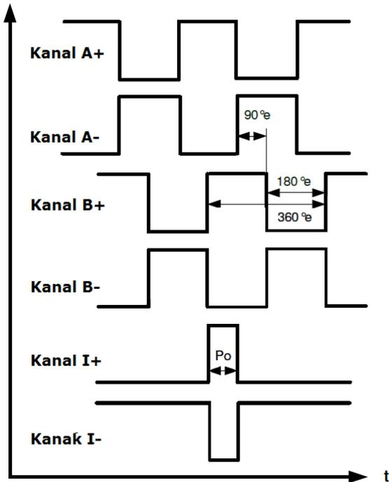
Inkrementelle Schnittstelle mit Differentialsignal
